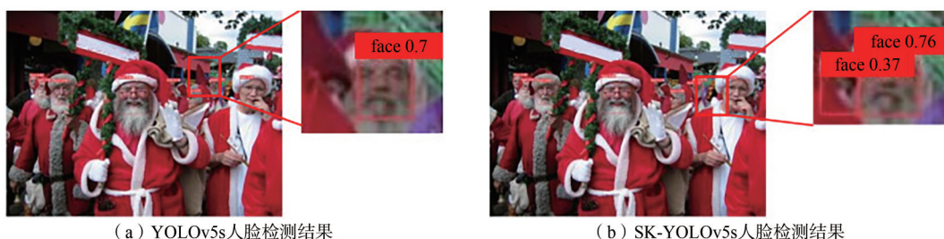
图6 YOLOv5和SK-YOLOv5s人脸检测结果对比
